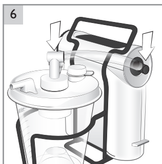
6 Sprawdzić solidność mocowania wszystkich złączy rurki podciśnieniowej.
