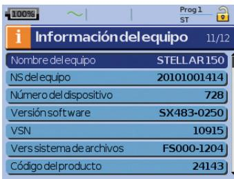
Esta pantalla muestra el número de serie (se muestra como NS del equipo), el número del dispositivo, la versión del software y las versiones de otros componentes. Los datos en esta pantalla pueden ser solicitados por un técnico para prestar servicio de mantenimiento o como parte de la solución de problemas.
