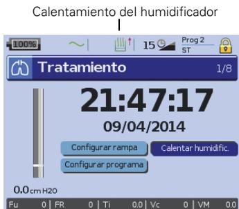
Puede utilizar la función de calentamiento para precalentar el agua en el humidificador antes de iniciar el tratamiento. El humidificador será detectado automáticamente cuando se encienda el dispositivo. La pantalla *Tratamiento* proporciona la opción de empezar el calentamiento del humidificador. Si el humidificador se está calentando, se verá el símbolo correspondiente en la parte superior del visor. Para más información, consulte el manual del usuario del H4i.
