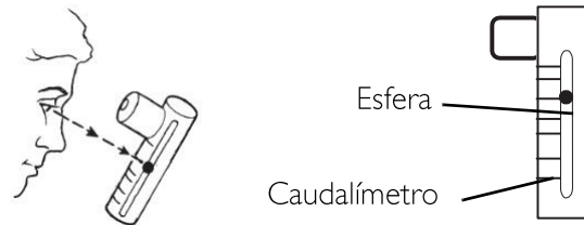
FIGURA 3 Configuración de la velocidad de flujo en el caudalímetro pediátrico
