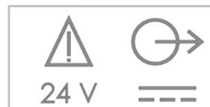
CONEXIÓN DE ALIMENTACIÓN INTERNA DC 24 V HACIA EL VENTILADOR
