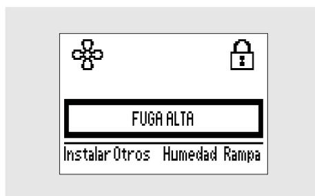
La alarma se puede oír con un tono y se puede ver con un mensaje en la pantalla.
