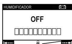
Indica que el humidificador no funciona debido a la conexión a la batería.
