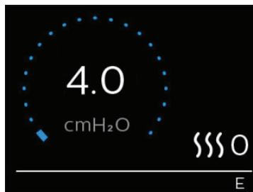
O seu dispositivo possui dois modos de rampa. O seu fornecedor irá selecionar o modo que melhor se adequar ao seu caso. O modo de rampa padrão aumenta a pressão a uma velocidade constante. Alternativamente, o modo SmartRamp mantém uma pressão inferior constante até o dispositivo detetar a necessidade de uma pressão superior.
